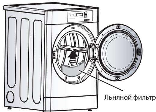
Для выполнения чистки откройте дверцу сушильной машины и потяните льняной фильтр в направлении строго вверх. Затем:
